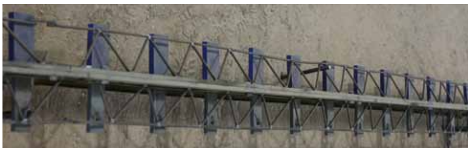
Fig. 1 : Le joint de construction permet à la fois de bloquer tout décalage de niveau entre les 2 pavés de coulage (évitant ainsi le pianotage) tout en laissant une liberté de mouvement horizontal.
